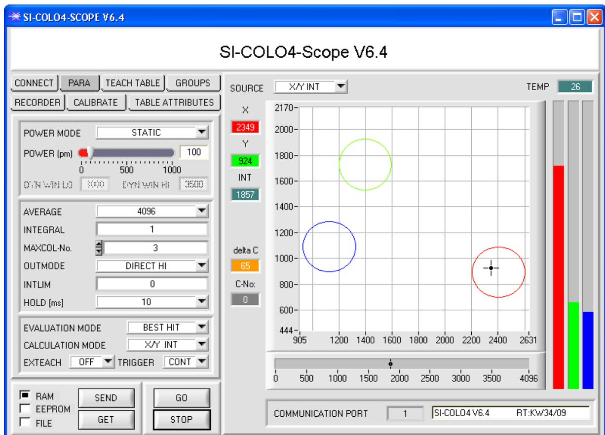
Im **CALCULATION MODE X/Y INT** und **s/i M** gibt **delta C** die Distanz zur Zylinderachse an.
