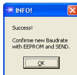
Nachdem die neue Baudrate erfolgreich übertragen worden ist arbeitet der Sensor mit der neuen Baudrate. Außerdem erscheint ein Popup mit der Aufforderung **EEPROM** zu selektieren und anschließend **SEND** zur drücken. Erst nach Drücken von **EEPROM** und **SEND** wird bei einem Hardware-Reset mit der neuen Baudrate gestartet.
